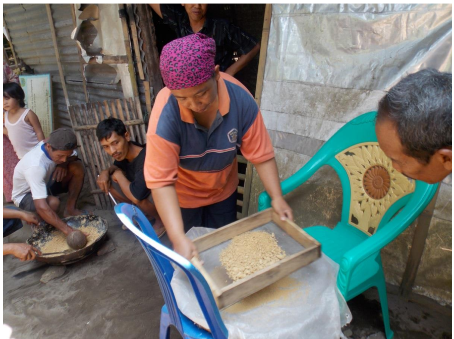
Gambar 12. Pembuatan gula kristal tahap pengayak.
