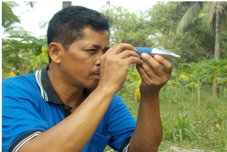
Gambar 6. Pengukuran Derajat Brix nira.
